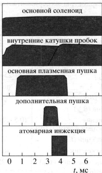
Рис. 2. Временная диаграмма работы газодинамической ловушки.
